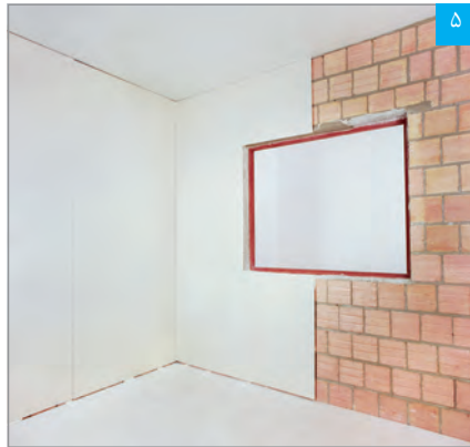
۵ در محل بازشوی پنجره، برش پنل به صورت «C» شکل صورت می‌گیرد
